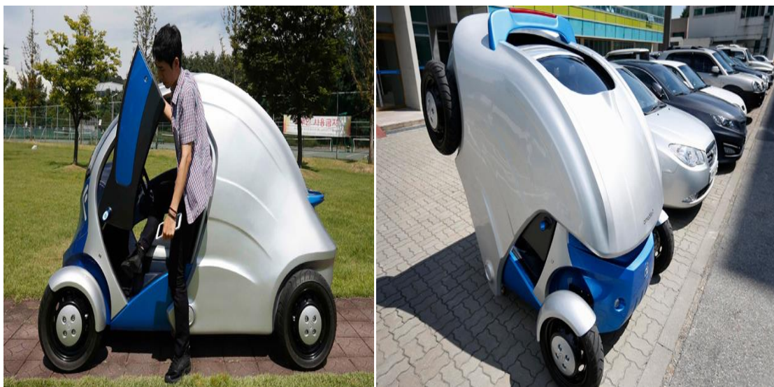
Armadillo- T το αυτοκίνητο που σηκώνεται προς τα πάνω και το μήκος τους να μειώνεται από τα 3,25 στα 1,65 μέτρα.
